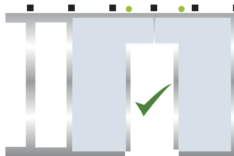
d) Puedes abarcar el área de la puerta con 2 placas cortando la placa en forma "tipo bandera" evitando dejar juntas de placas en aristas de puertas y ventanas.
